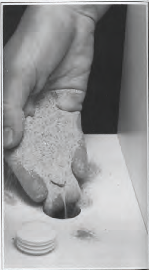
Getrockneter Sand im Fußteil des Ständers vermindert Resonanzen und sorgt für Standfestigkeit
